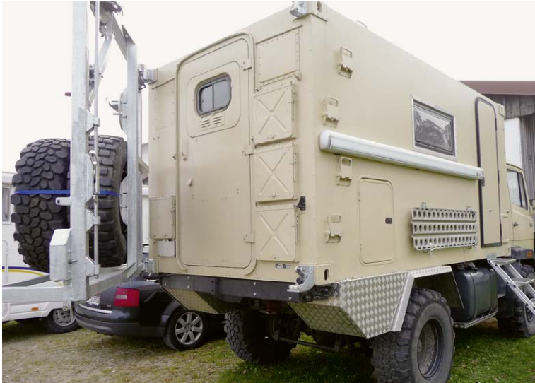
Schwenkbarer Heckträger mit Ersatzradhalterung, Motorrad- oder Fahrrad-Plattform und Seilwinde
